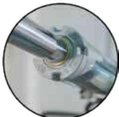
Cilindri idraulici con guarnizioni antipolvere.
