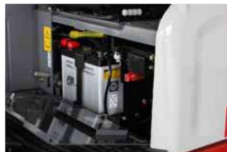
Batteria posizionata nel vano sotto il sedile.
