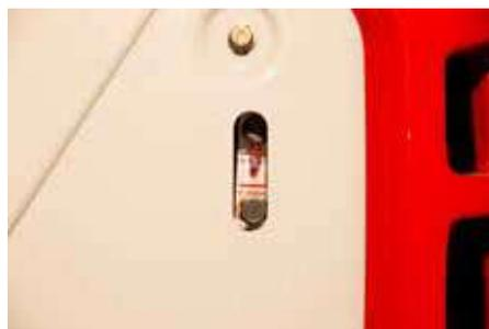
Controllo del livello olio idraulico.
