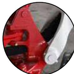
Le tubazioni idrauliche passano all'interno del braccio per ridurre il rischio di rotture causate da detriti o durante operazioni in aree molto strette.
