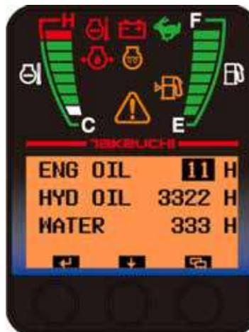
Computer di bordo per facilitare la manutenzione della macchina con la visualizzazione del contatore dell'olio motore, olio idraulico e liquido refrigerante, ecc...
