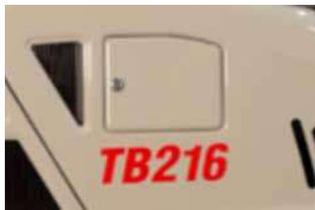
Controllo a vista del livello gasolio. Vano protetto da chiave contro gli atti vandalici.
